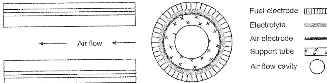
Solid oxide fuel cell (tubular shape).
