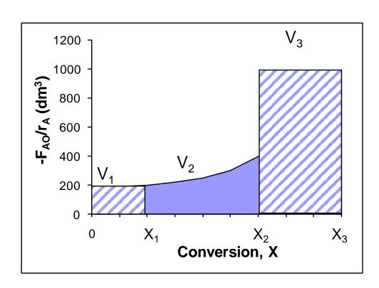
$$V_1 = \frac{F_{A0} X_1}{-r_{A1}}$$
